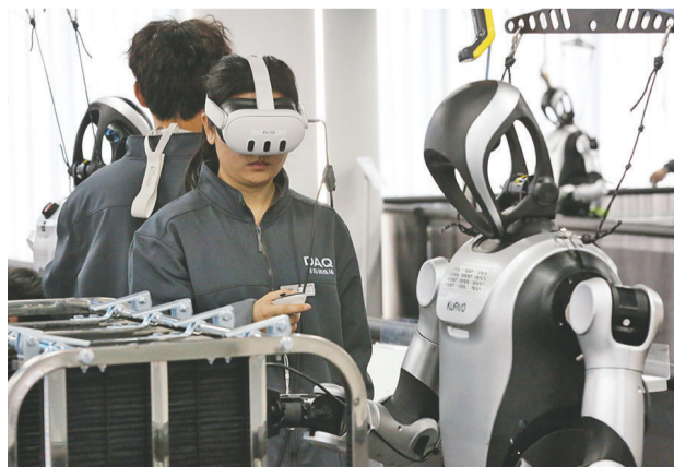
数据采集员头戴VR设备、手持感应手柄，指导机器人完成动作。
