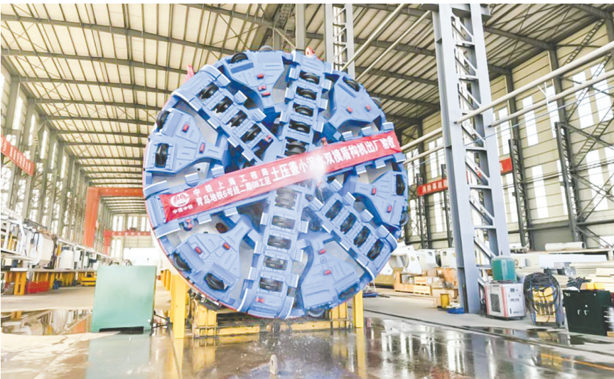
国内首台“土压+微泥水”双模盾构机在地铁 6 号线成功应用。 地铁供图
