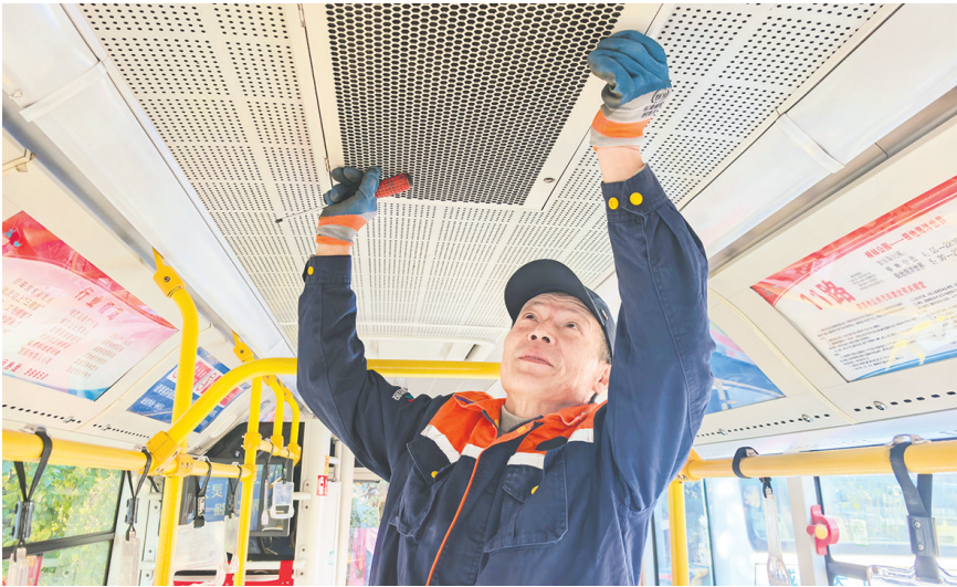
工作人员对空调车辆的暖风系统进行集中检修与清洗。
