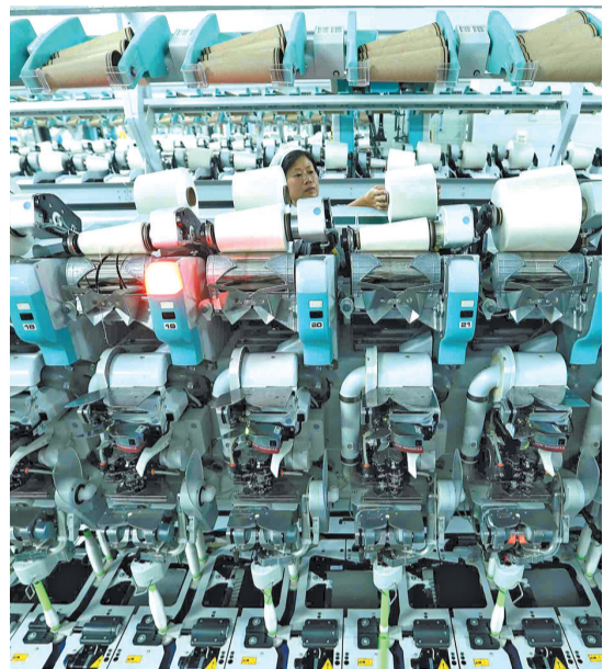
工人在自动络筒机前检查成品纱线质量。
