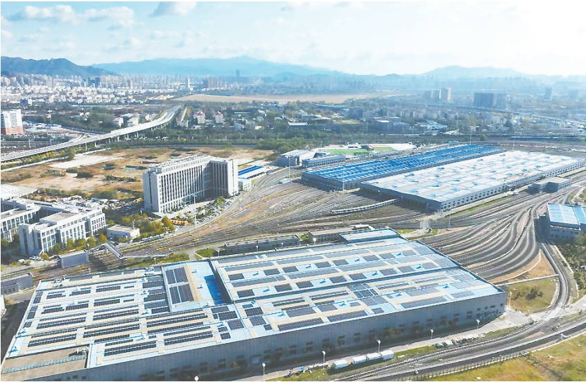
青岛地铁让车站、车辆段屋顶变成绿色电站。地铁供图
