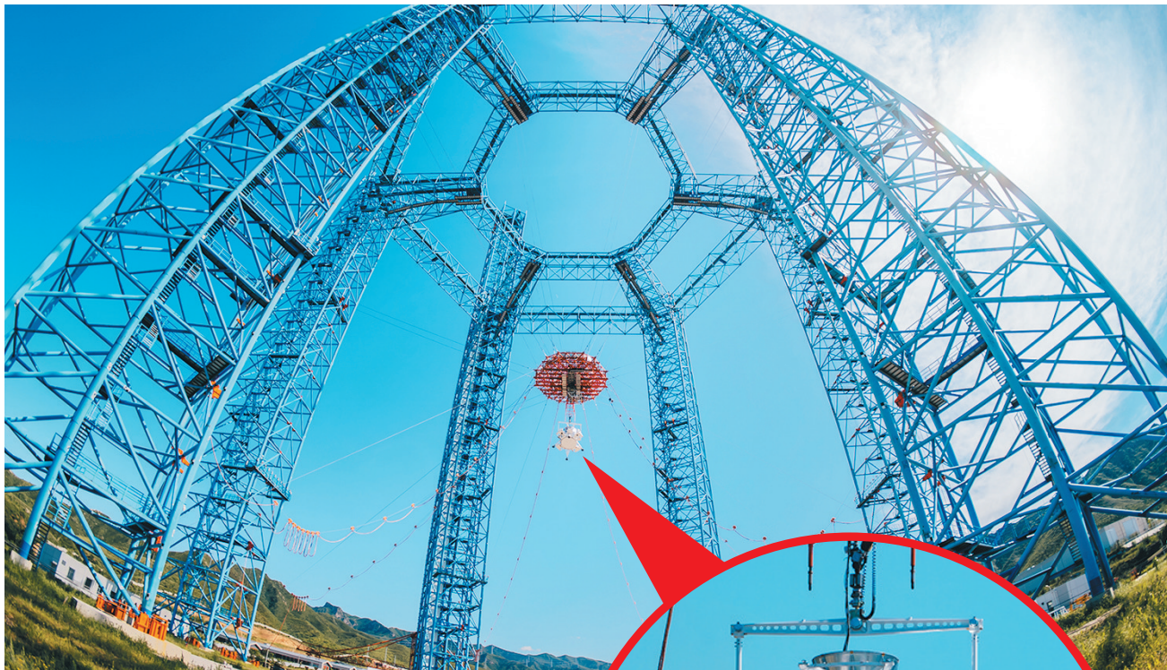
组图:揽月月面着陆器在地外天体着陆试验场进行测试。
