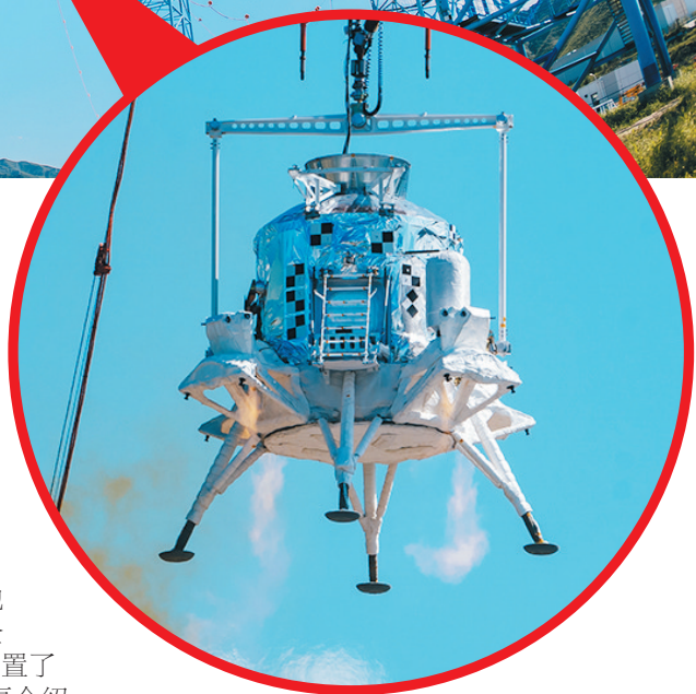
组图:揽月月面着陆器在地外天体着陆试验场进行测试。
