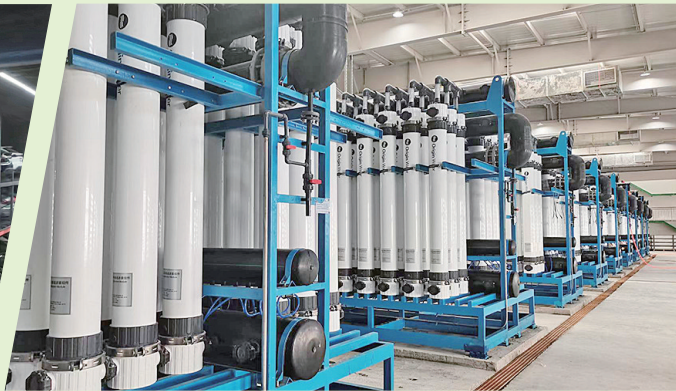
百发生产车间内的海水淡化设备。企业供图
