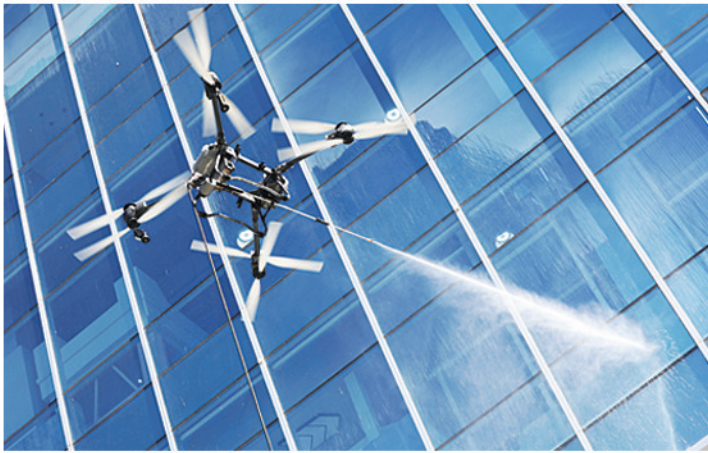
组图：无人机在高空清洗大楼。
