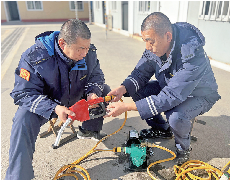
任全国(左)和同事一起给抽取式防冻液加注枪安装连接管。
