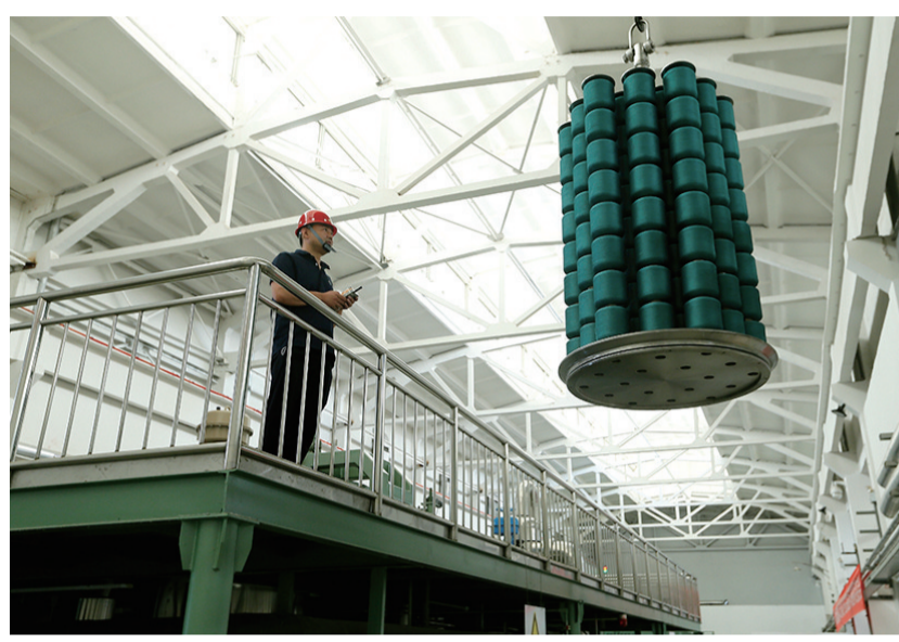
即发集团的技术工人在超临界二氧化碳无人染色产业化示范线上生产筒子纱产品。
