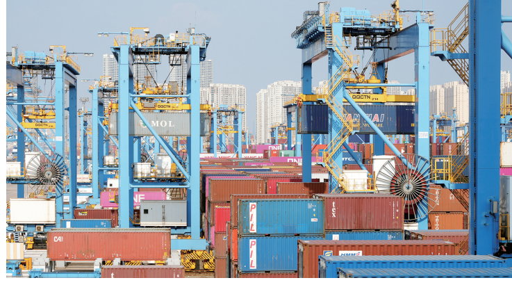
山东港口青岛港自动化轨道吊正在作业。
