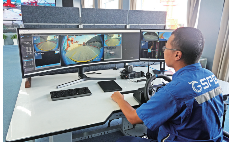
山东港口青岛港IGV(自动化水平运输车)操作人员正在作业。
