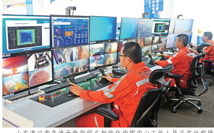
山东港口青岛港干散货码头智能化指挥中心工作人员正在远程操作门机作业。
