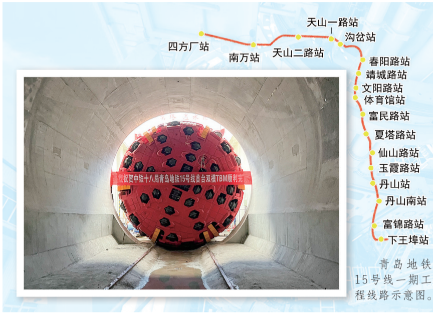
“青龙号”双护盾土压组合式掘进机。
