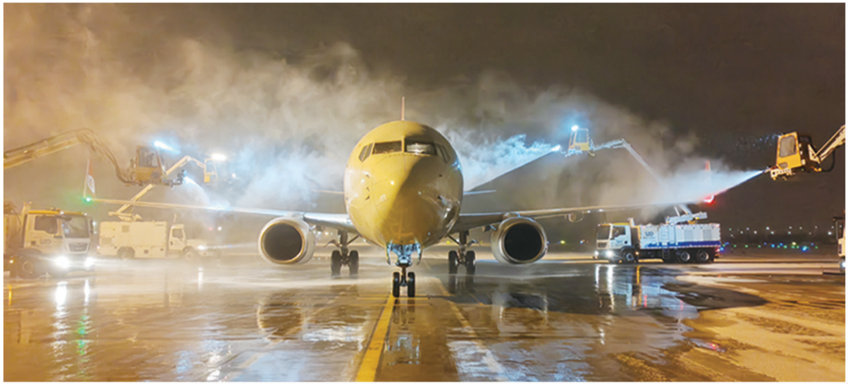
青岛航空机务工程部航线维修分部工作人员为飞机除冰雪。机场供图
