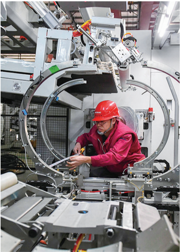
2月16日 技術人員在青島軟控裝備產業園安裝調試智能化輪胎成型機。隨著各地工業生產恢復,智能制造裝備的需求也在復蘇。
