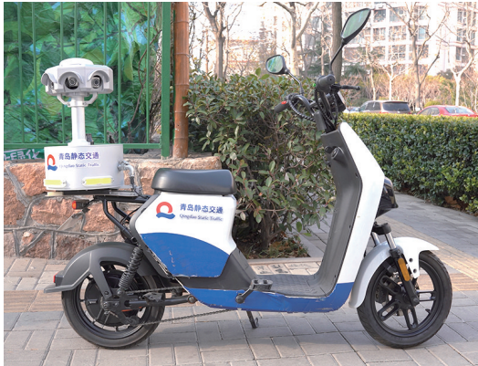
搭载路内泊车智能化巡检设备的电动巡检车。
