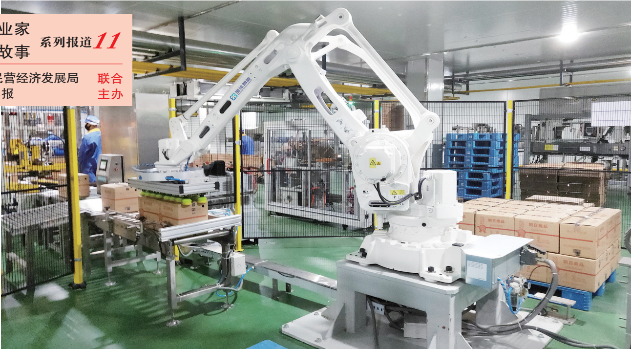
宝佳智能生产的机器人在码垛货物。
