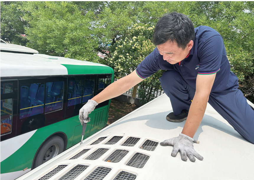
王盟川爬到车顶检修空调系统。
