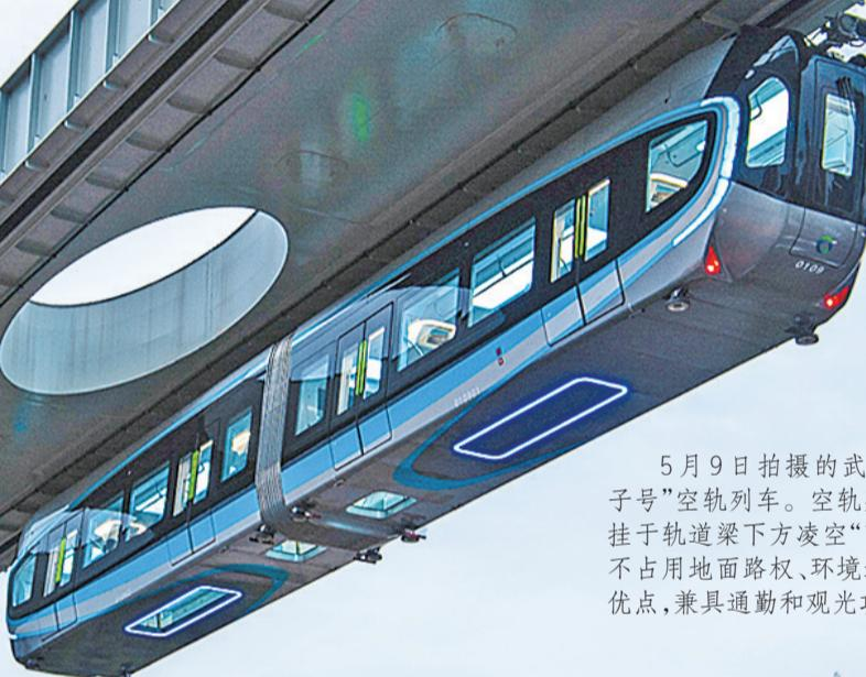
5月9日拍摄的武汉“光谷光子号”空轨列车。空轨列车车体悬挂于轨道梁下方凌空“飞行”，具有不占用地面路权、环境适应性强等优点，兼具通勤和观光功能。
