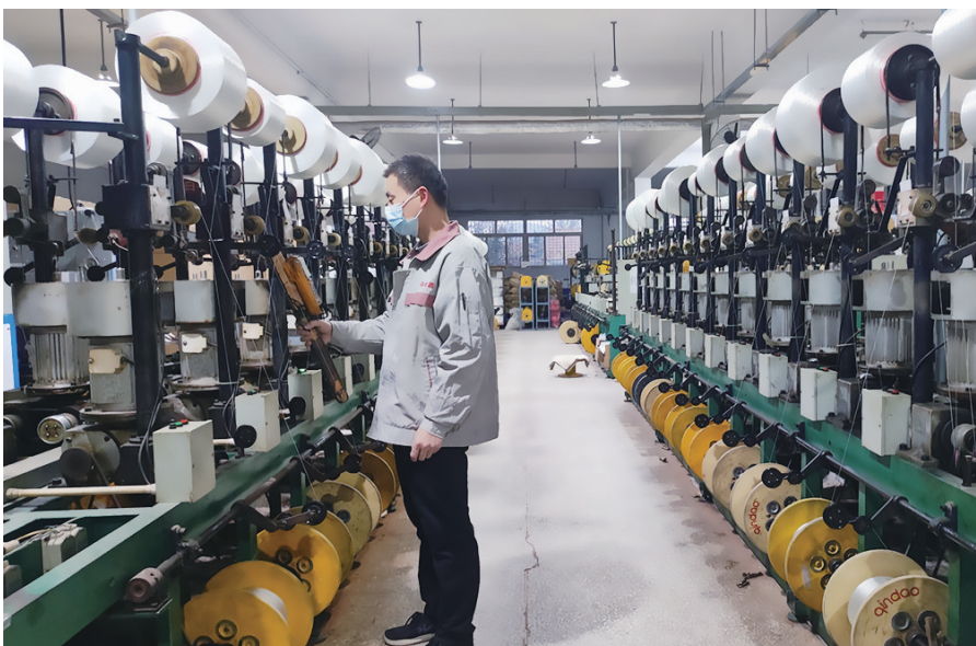
在发热线生产车间,工人正在测试发热线内层丝电阻数据。
