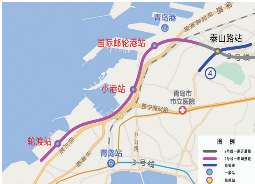
地铁2号线一期工程调整(轮渡站—泰山路站段)线路走向示意图(图中站名为工程命名)。
