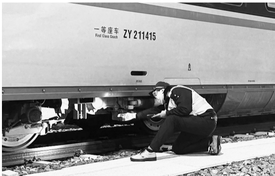
地勤机械师对动车制动设备进行巡检。青岛动车段供图
