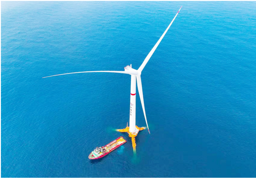
今年8月6日,全球首座16兆瓦张力腿浮式风电平台“海油安澜号”接入陆丰油田电网。该平台浮体结构由海油工程青岛基地建造。
