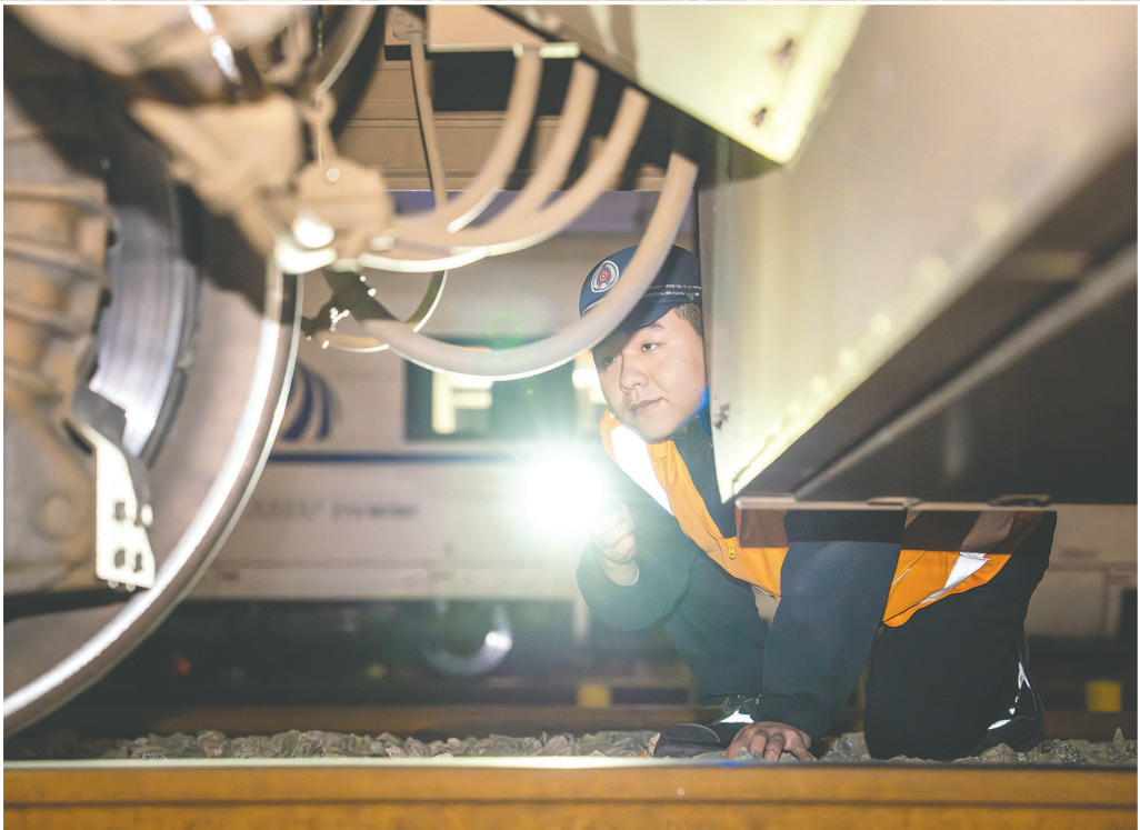
青岛动车段地勤机械师检查动车组车下走行部设备。国铁济南局动车段供图
