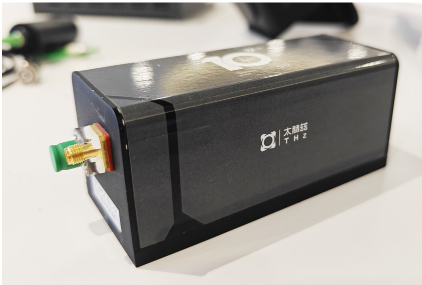
光纤耦合光导天线应用于光纤式太赫兹时域光谱和成像系统。
