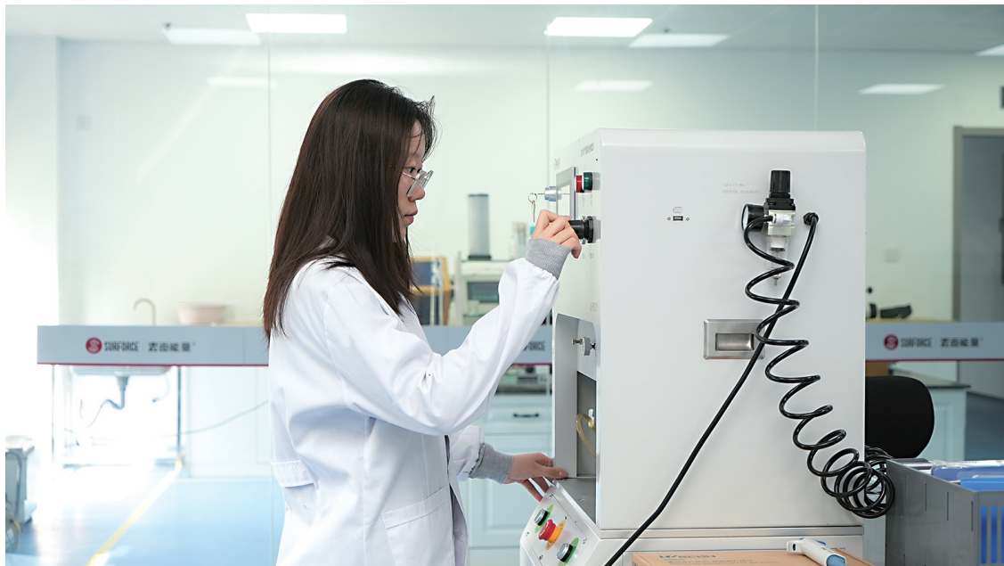
实验人员在操作防水透气测试仪器。企业供图
