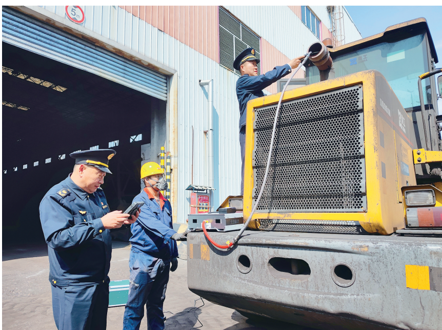
市生态环境局崂山分局工作人员在给非道路移动机械采样。
