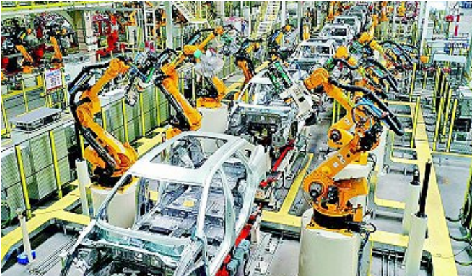
即墨区一家汽车公司焊装车间,机器人在进行焊接作业。 梁孝鹏 摄
