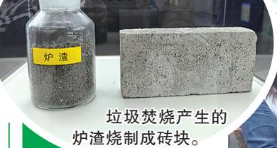
垃圾焚烧产生的炉渣烧制成砖块。
