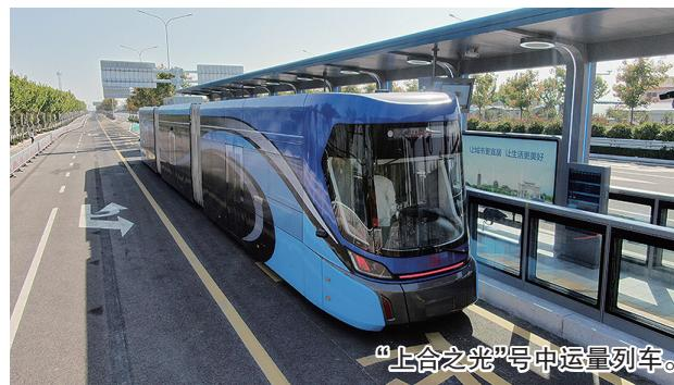
约0.5~3万人次。上合新区中运量交通列车命名为“上合之光”号,采用以磁标签为导向的虚拟轨道胶轮电车,同时利用卫星导航、车辆光学识别车道标线,形成多维度数字化虚拟轨道,最高运行速度70公里/小时。这是山东省首条胶轮虚拟轨道中运量线路。
