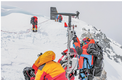
科考登顶队员在珠峰海拔约8830米处维护升级自动气象站。
