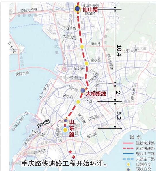
辅助车道)高架向北敷设,继续向北采用一对定向匝道实现与福州路东-北方向衔接,采用双向10车道(含辅助车道)高架向北敷设,在长沙路节点设置双跨线分离式立交,向北采用双向6车道高架接入已建成跨海大桥高架路,继续向北采用双向6车道高架跨过振华路后,在金水路设置双跨线分离式立交,在唐山路节点设置东南象限单环互通立交,向北跨过遵义路、瑞金路后,高架主线近期在仙山路以南约160米处临时接地,仙山路节点设置T型部分互通立交,工程终点位于重庆路与仙山路交叉口。
