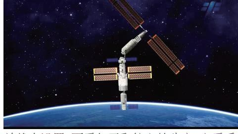
关状态设置,而后与天和核心舱分离,之后采用平面转位方式完成转位,并与节点舱侧向端口再对接。这是我国首次利用转位机构在轨实施大体量舱段转位操作。问天实验舱转位完成后,空间站组合体由两舱“一”字构型转变为两舱“L”构型。
