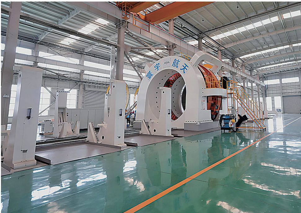
■青岛寰宇航天液体火箭低温推进剂贮箱柔性化制造产线。
