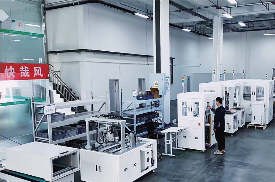
■墨氮智能车间内,工人操作设备为功率模块“体检”。
