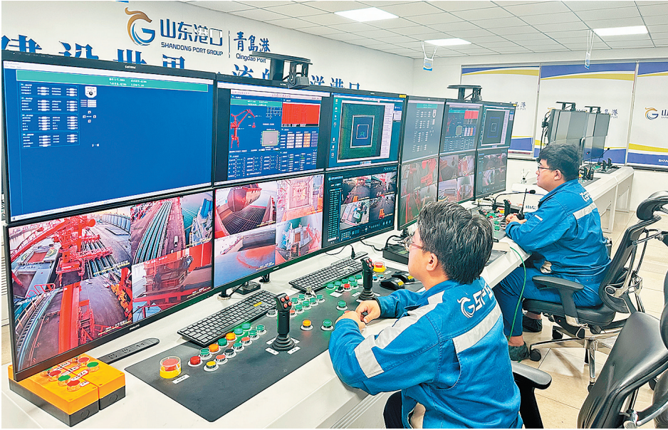
■在山东港口青岛港前湾港区,司机在操作台前远程控制门机作业。
