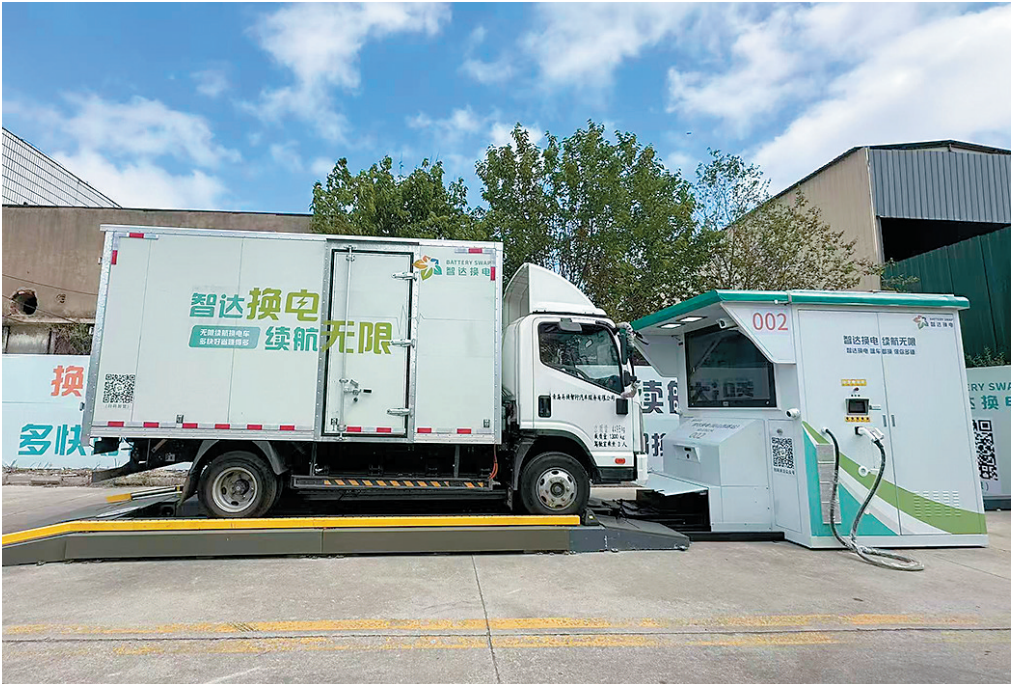
■联合新能源研发的第五代换电站占地两个停车位，可灵活部署于停车场等场景。
