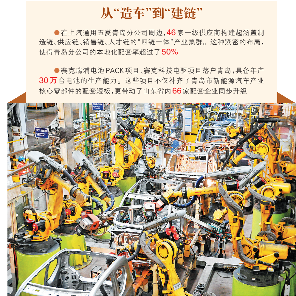
■上汽通用五菱青岛分公司车身车间，工业机器人正在焊接宏光 MINIEV 门盖。
