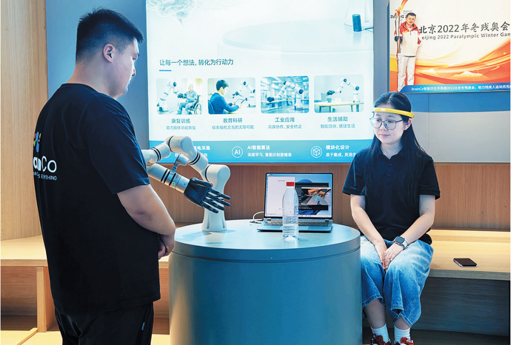
■在强脑科技探索空间,体验者佩戴脑电波采集头环,通过集中注意力驱动机械臂抓取矿泉水瓶。 曹 森 摄
