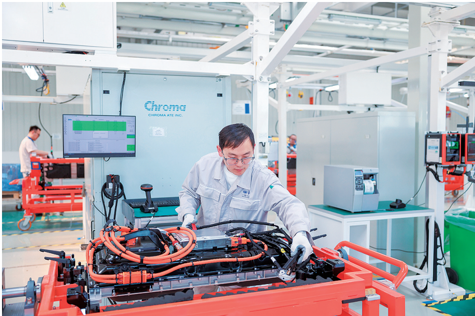
在一汽-大众华东基地 HEV 电池车间,工人组装电池包。
