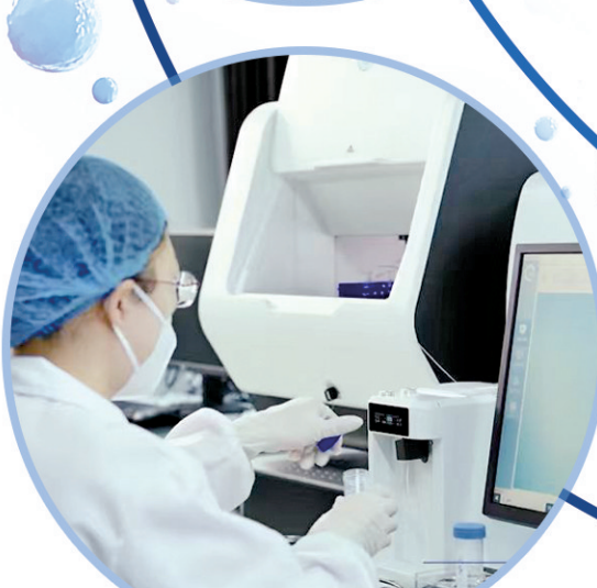
■星赛生物实验室内，工作人员使用拉曼流式细胞分选仪Flow-RACS分析并分选样品中的功能单细胞。
