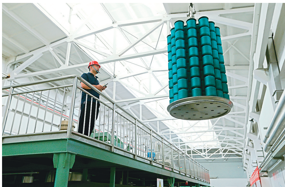
即发集团有限公司超临界CO 2 无水染色生产线上生产聚酯纤维筒子纱。梁孝鹏 摄
