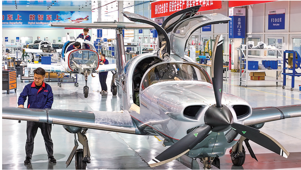
工人在莱西万丰飞机生产基地组装DA50飞机。
