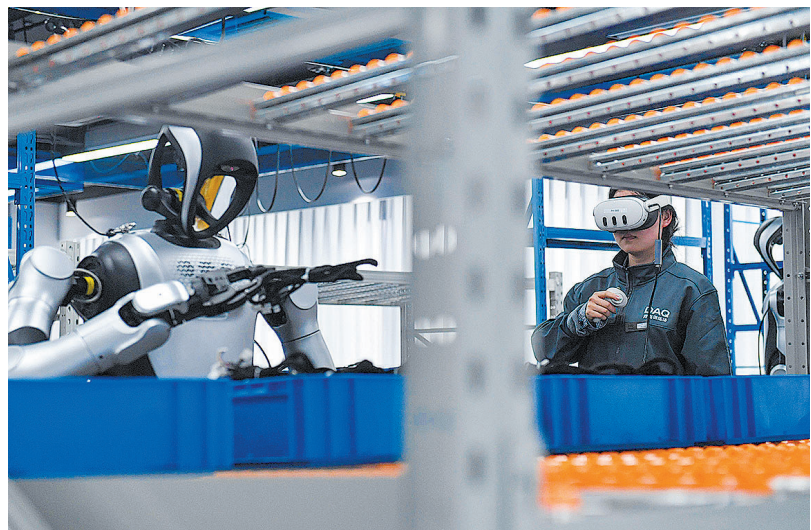
■数据采集员头戴VR眼镜操控机器人分拣汽车零部件。赵健鹏 摄
