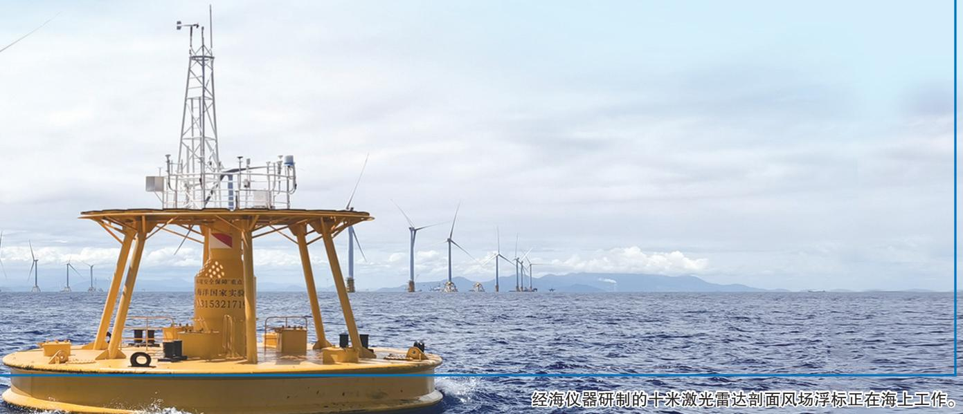
经海仪器研制的十米激光雷达剖面风场浮标正在海上工作。
