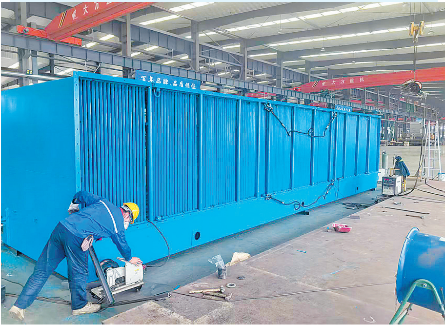
■工人在车间进行除尘器焊接组装。
