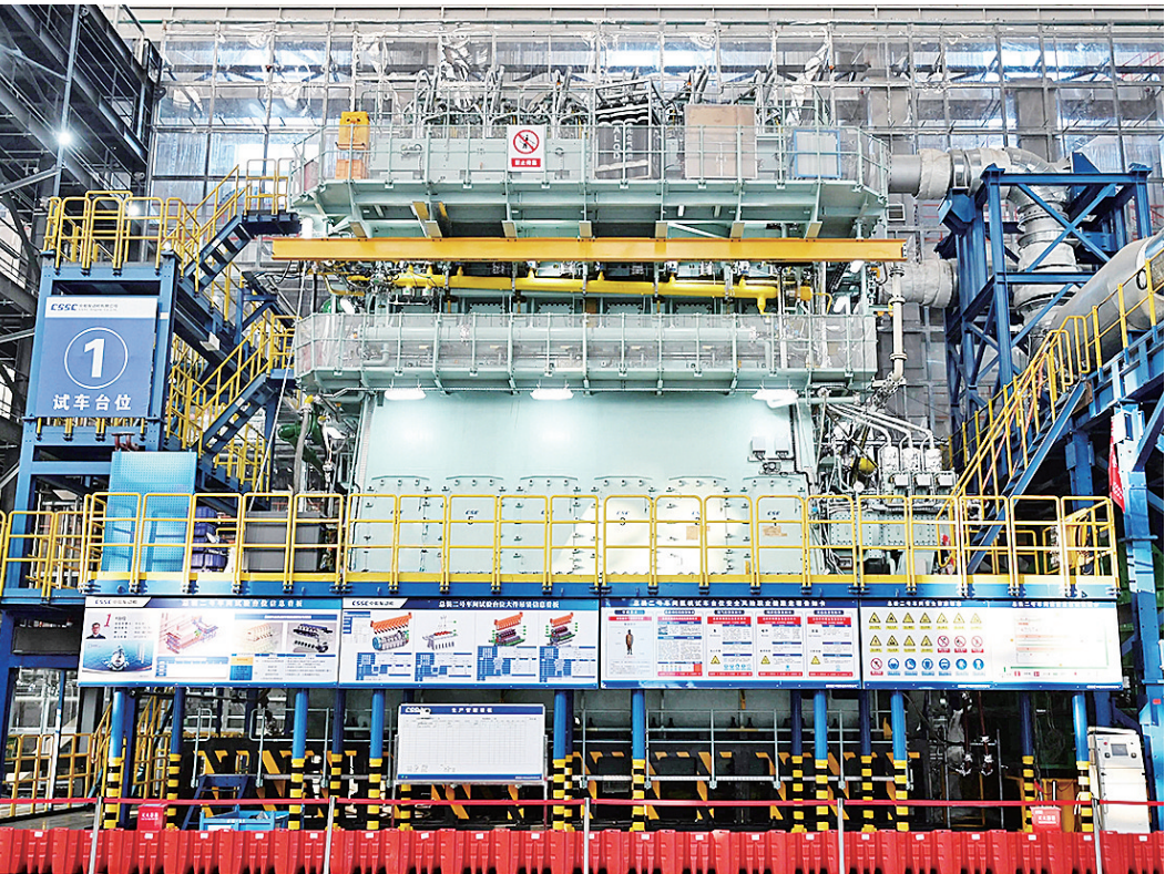
■中船集团中船发动机首制 X72DF-A 氨燃料低速发动机。
