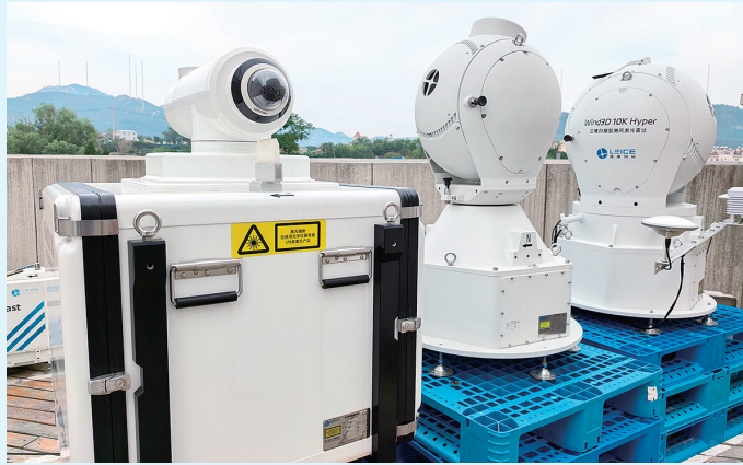
■镭测创芯研发的三维扫描型测风激光雷达设备。韩 星 摄
