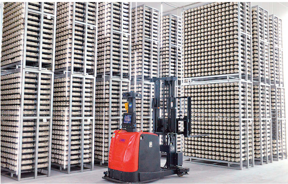
位于莱西市的艾泽福吉菌棒培养车间内,AGV(智能搬运机器人)正在搬运菌包。 邢志峰 摄
