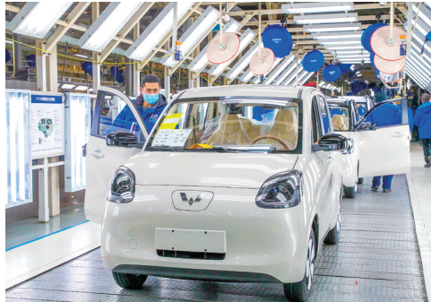
上汽通用五菱青岛分公司生产车间内,工人在进行新能源汽车下线前的检验作业。 张进刚 摄
