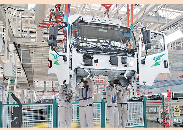
■一汽解放青岛汽车有限公司总装配二车间的工人正在进行驾驶室底装作业。
